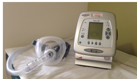
Figura 4. Circuito de VNID: ventilador mecánico domiciliario, tubuladura, interfase y cinchas
