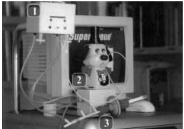
Figura 1. Sistemas de biofeed-back que se activan durante la maniobra de exhalación lenta contra resistencia, para obtener flujos y presiones estables durante toda la espiración.
